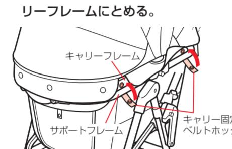
1. サポートフレームのキャリー固定ベルトホック(左右各2カ所)をキャリーフレームからはずす。
