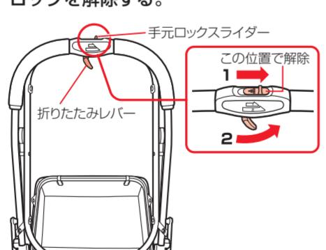
2. 折りたたみレバーを握りながら、後車輪を支点にして矢印方向に倒す。
